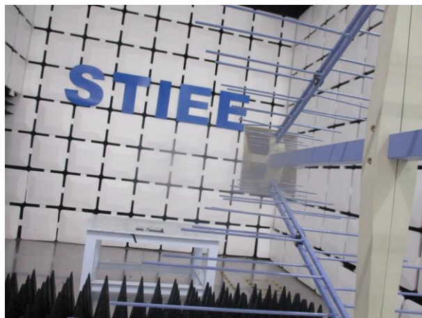
射频电磁场辐射 (80-1000MHz 水平) 试验布置图
