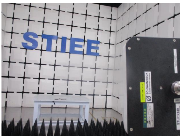
射频电磁场辐射 (1400-2700MHz 垂直) 试验布置图
