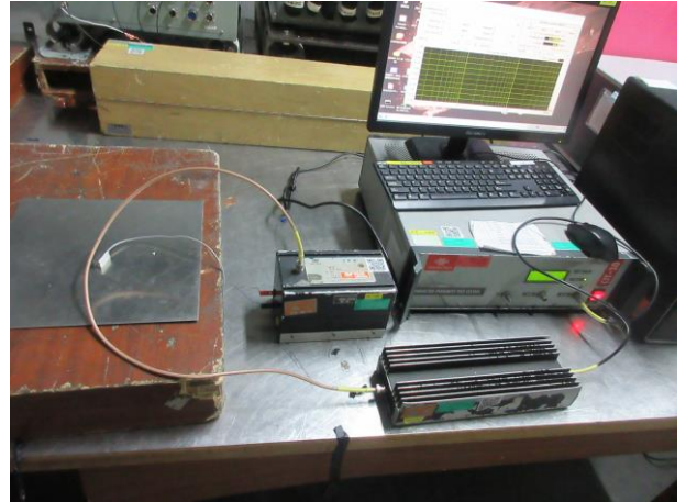
射频场感应的传导骚扰试验布置图
