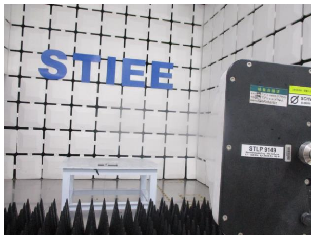
射频电磁场辐射 (1400-2700MHz 水平) 试验布置图
