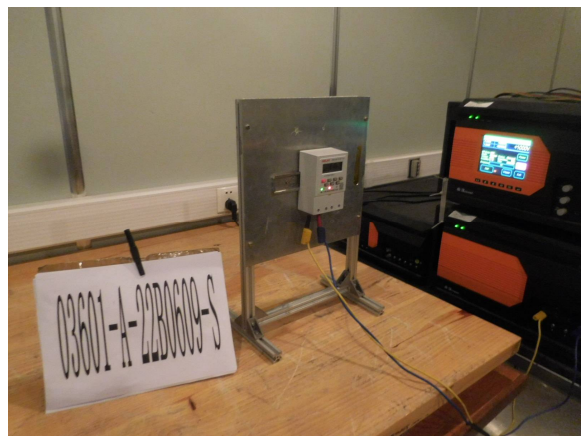
浪涌抗扰度试验布置图
