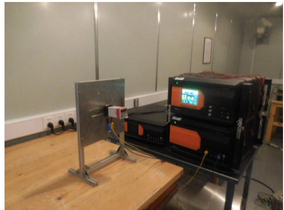
浪涌抗扰度试验布置图
