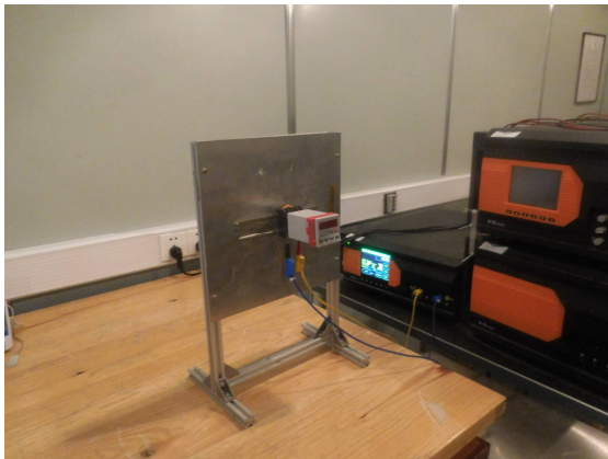
电快速瞬变脉冲群抗扰度试验布置图
