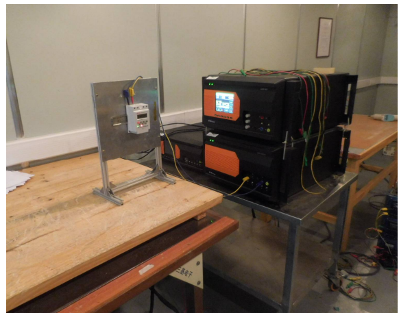
浪涌抗扰度试验布置图
